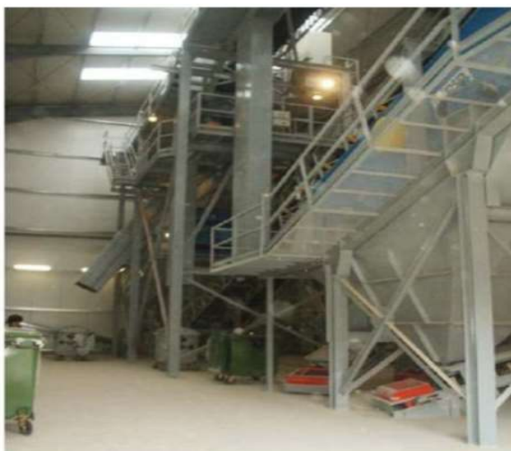
3. 20. Ábra Törő-, aprító- és osztályozó gépsor
