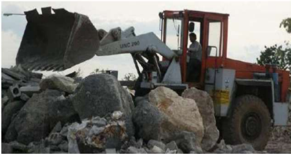
3. 18. Ábra Nagy teljesítményű markológép a nagydarabos építési törmelék mozgatásához
