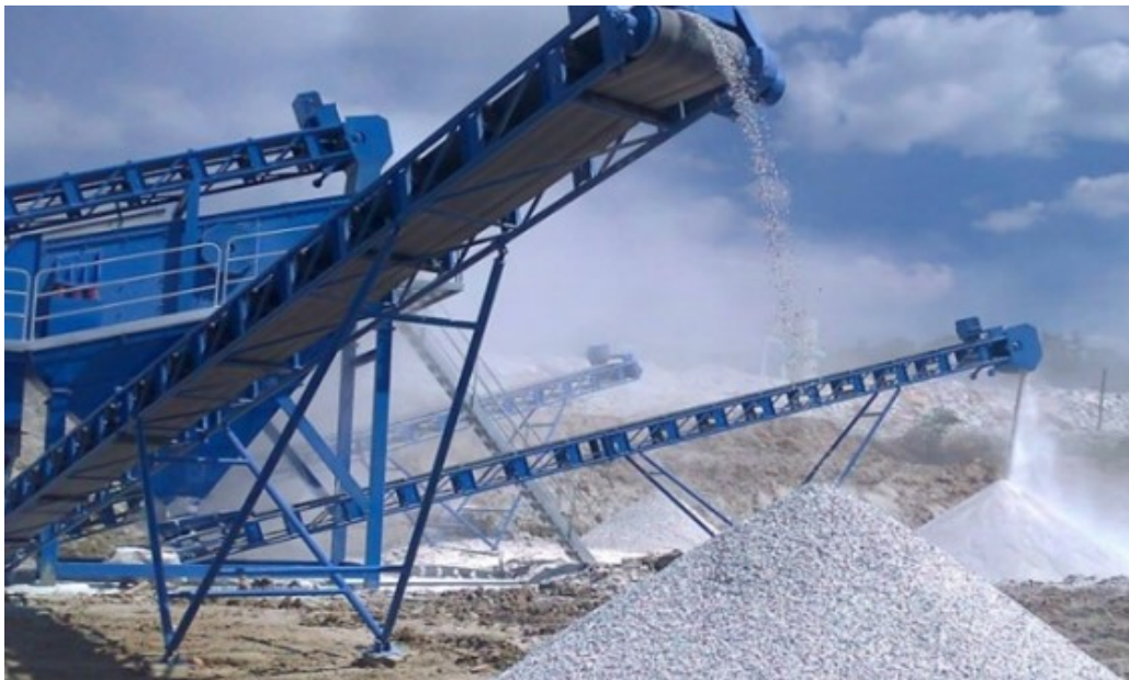
Pav. 4. 7. Marmuro atliekų perdirbimo įrenginys (Haber 48, 2020).
