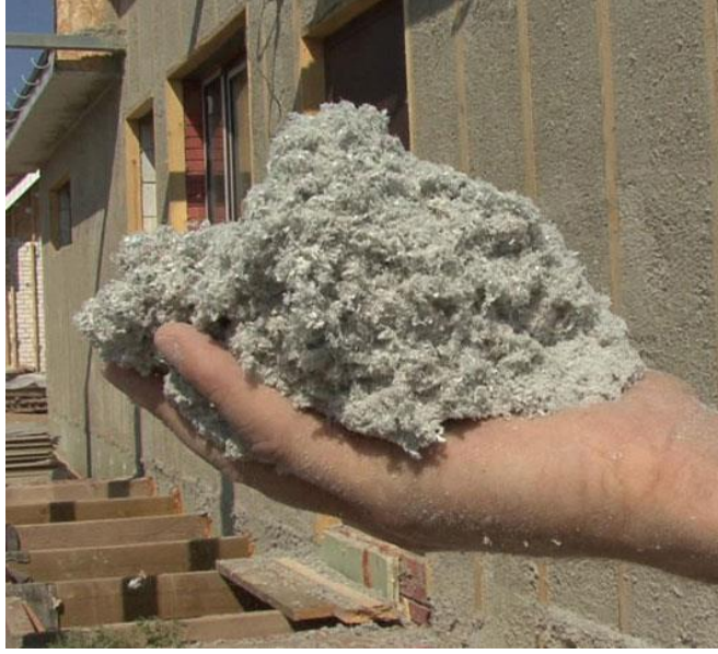
Şekil 5. 12. Çevre dostu yün kullanarak binaların ısıtılması.
