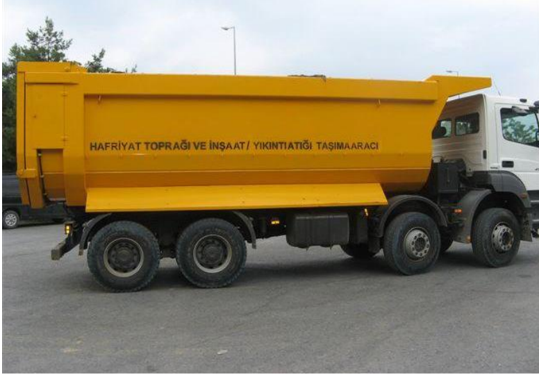
Şekil 4. 9. Kazılmış toprak ve inşaat ve yıkım atığı taşıma aracı.
