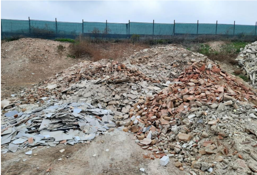
Şekil 4. 2. Geri dönüşüm tesisine getirilmiş inşaat ve yıkıntı atıkları.
