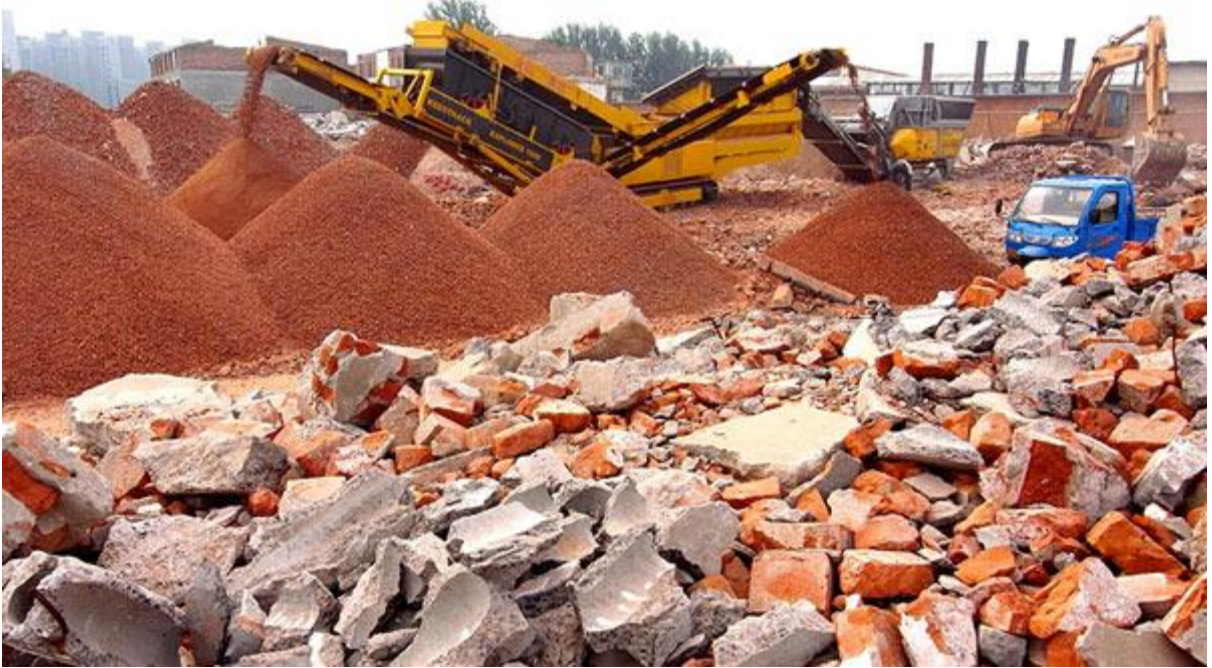
Şekil 2.3. Tuğla, kil, beton gibi malzemeler içeren inşaat atıklarının işlenmesi
