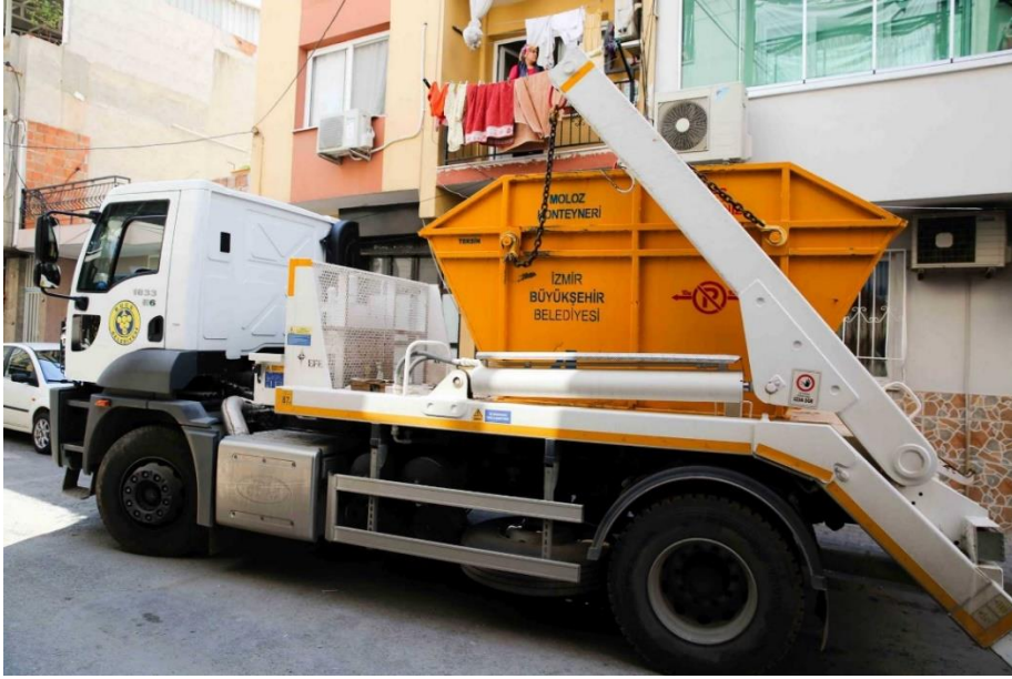
Şekil 4. 8. İnşaat ve yıkıntı atıkları için tahsis edilen konteyner (Buca Belediyesi, 2019).
