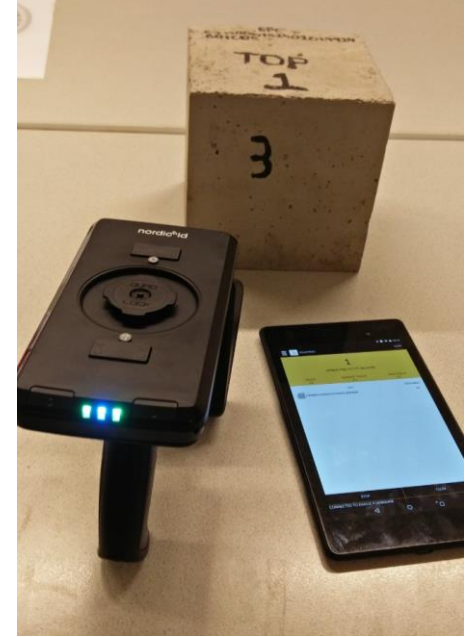
Betonda okunabilirliğin değerlendirilmesi
