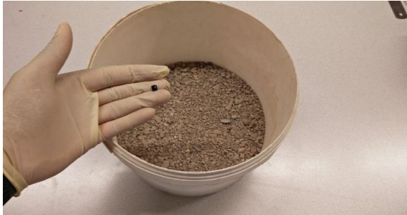
Agregada RFID etiketi
